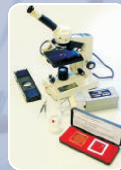
Equipamentos utilizados em procedimento de Flushing Norma NAS-1638
